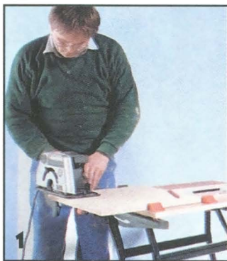
Из ДСП толщиной 19 мм выкраивают детали корпуса.
