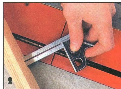
Направляющую линейку приспособления выставляют под расчетным углом к пильному диску и на нужном расстоянии от верхней точки диска.
