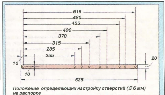
Рис. 3. Приспособление для выпиливания вогнутых галтелей.
